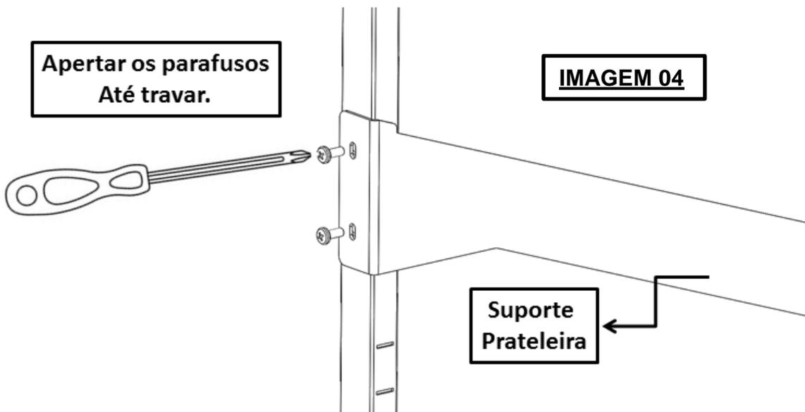
**4º Passo** - Após fixar os 06 suportes (03 Direito e 03 Esquerdo), o próximo passo é encaixar as prateleiras no recorte do suporte, conforme imagem 05.
