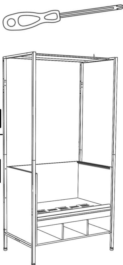
**3º Passo** - Após fixar os 04 tubos, o próximo passo é posicionar e parafusar os suportes prateleiras conforme imagem 04.
