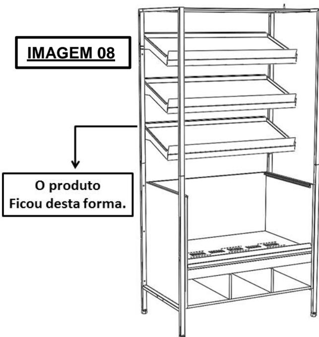
**6º Passo** – Ajustar a chapa niveladora de pães na inclinação desejada, quanto menor a inclinação maior a quantidade de pães.
