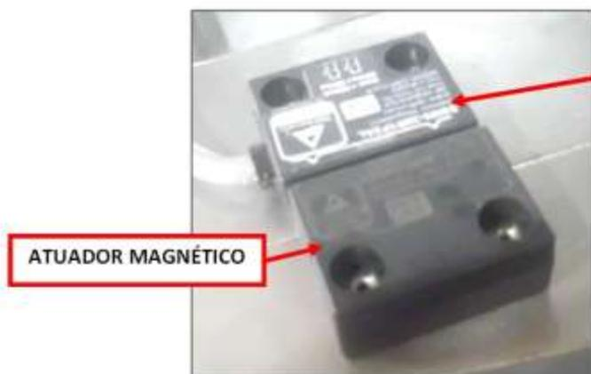
FIG. 12: Chave de Segurança Magnética Instalada na tampa superior do equipamento
