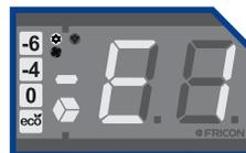
E1: Sonda do Evaporador
