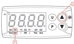
Para Degelo Manual - VCFC: Para iniciar um degelo manual, basta pressionar simultaneamente as teclas identificadas com n°1. na figura a seguir durante 5 segundos, até o LED indicador n°2 acender.
