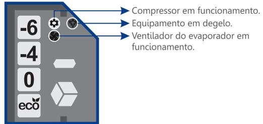
O controlador pode ser programado em uma faixa de temperatura de -6,0 °C, -4,0 °C, 0,0 °C e +2 °C (Função eco). Basta pressionar o botão de set point encontrado na parte esquerda do controlador por 15 segundos. (T1 = -6,0 °C / T2 = -4,0 °C / T3 = 0,0 °C / T4 = +2 °C),
