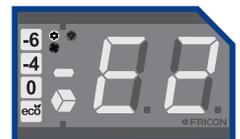
E2: Sonda do Evaporador
