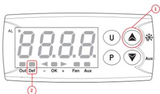
**Para Degelo Manual - VCFC:** Para iniciar um degelo manual, basta pressionar simultaneamente as teclas identificadas com nº1. na figura a seguir durante 5 segundos, até o LED indicador nº2 acender.
