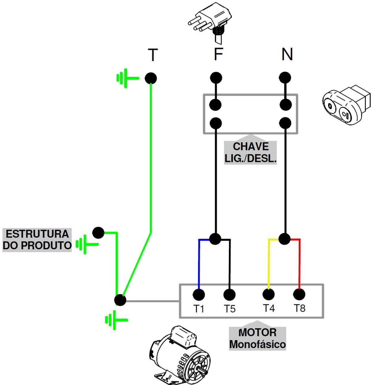
NOTA: Motor com sentido duplo de rotação. Para inverter a rotação, trocar o T5 pelo T8.
