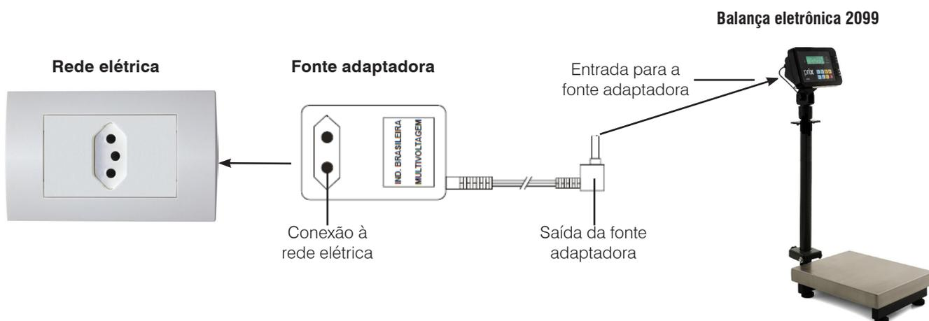
Ao ligar na energia elétrica, a balança eletrônica 2099 é inicializada automaticamente onde é realizado um teste de hardware, que consiste em:
